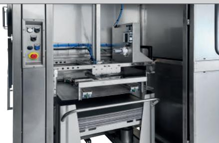
Ein Vakuumsystem hebt durch Pneumatik die Bleche vom Ablagewagen in das Reinigungssystem.
