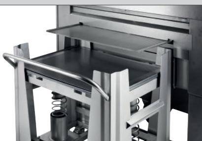
Die Bleche werden durch das einzigartige Bürstensystem geführt und fallen direkt in den Blechwagen. Nach Anlagenstopp werden beide Blechwagen in kürzester Zeit ausgetauscht und das System wird erneut gestartet.
