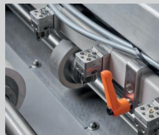
Neu-entwickeltes Spray System, das hygienischen KEG-Rücknahmesystem mit 6 Düsen in Reihe, sorgen für ein gleichmäßiger Beölung der Blechen. Ein gleichmäßig anstehender Materialdruck mit Armix Düsen realisieren ein sparsames und nebel freies Sprühbild. Hauchdünn werden alle Bleche eingefettet.
