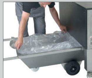
*Gelöster Schmutz der Bleche fällt in einen Schmutzablagewagen, der für eine leichte Entleerung auf Rädern montiert ist.*
